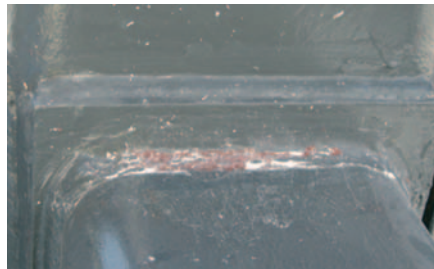
Mit Modellgips und Farbe verdeckte Schweißnähte
